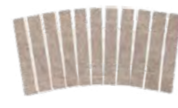
REJILLA CERÁMICA CURVABLE EVACUACIÓN: 19 m³/h GR-2356 PZ/123 500 x 245 x 25
